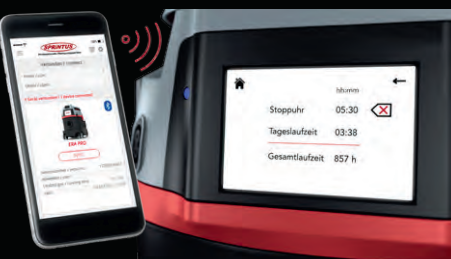
Lecture / synchronisation des données de l'appareil via l'interface Bluetooth.
